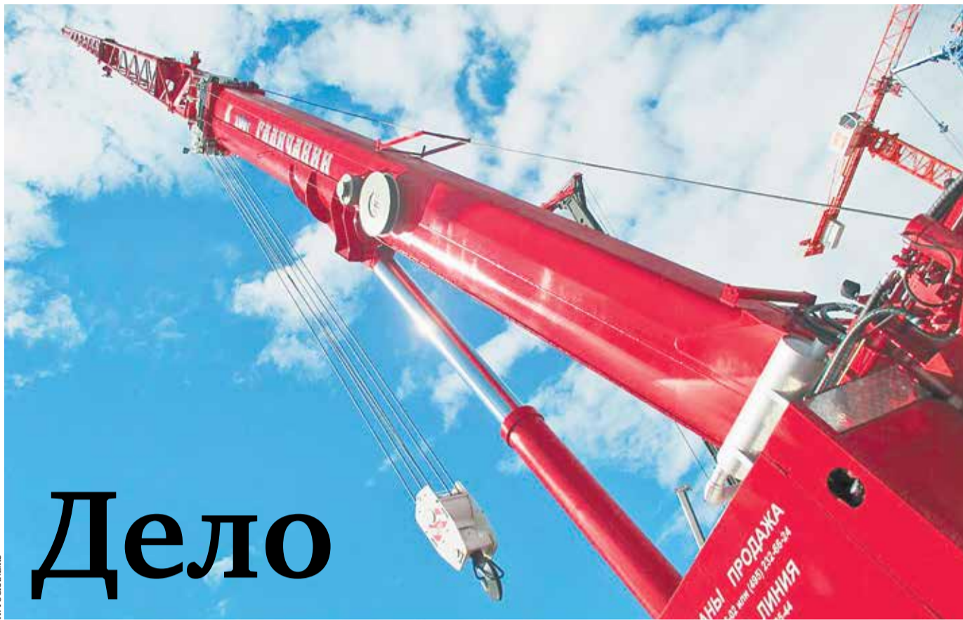
100-тонный автокран KC-85713
