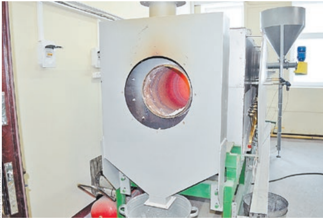
Специалисты НИИЖБ предлагают использовать стеклогранулы в качестве наполнителя при производстве низкотеплопроводных бетонов. На фото: экспериментальная печь для изготовления гранул
