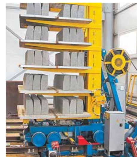
последних разработок завода связана с запуском в производство автоматизированной системы перевозки отформатированных изделий (технологических поддонов). Она оснащена специальными датчиками и видеокамерами и запрограммирована на доставку готовых изделий в зону термообработки, а затем разгрузки и складирования. Робот самостоятельно доставляет груз из точки А в зоне производства в точку В в зоне термообработки. Оператор следит за этими действиями в онлайн-режиме на мониторе.
