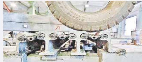
Это стало основой для нового испытательного-нормативного центра для мостовых конструкций, где сегодня испытывают на многократную нагрузку новый деформационный шов отечественного производства «СК Кар» из гладкотянутых цельных металлических профилей, мостовой стали 09Г2С.
