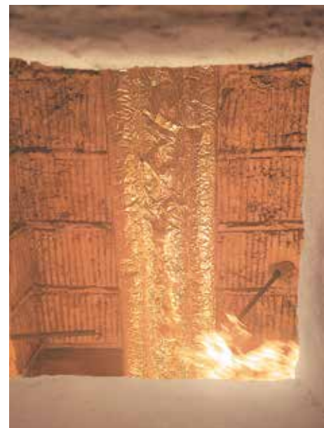
Огневые испытания системы «ЕТ ДРЕВО»
