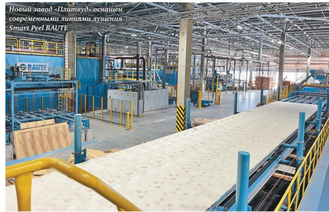
Новый завод «Плитвуд» оснащен современными линиями лущения Smart Peel RAUTE
