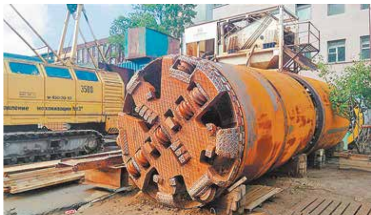
Проходческий щит двигался под землей со скоростью до 20 м в сутки
