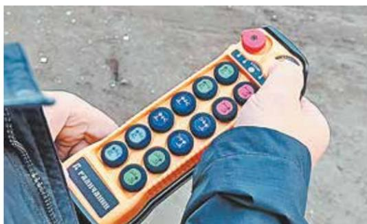
Пульт дистанционного управления опорами автокранов ГАЛИЧАНИН грузоподъемностью от 50 до 100 тонн
