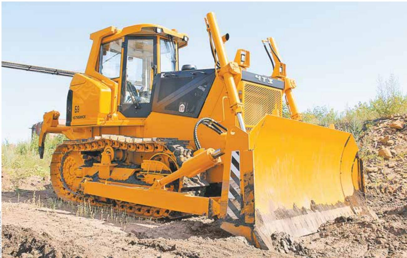
Бульдозер ЧТЗ-Уралтрак предназначен для борьбы с природными пожарами и прокладки защитных полос
