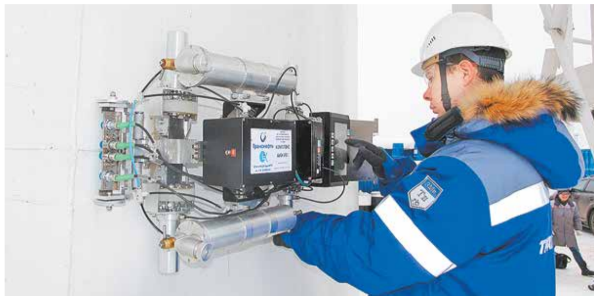
На полигоне АО «Транснефть-Диаскан» (Луховицы, Московская область) с помощью опытного образца комплекса автоматизированного ультразвукового контроля была проведена проверка сварных соединений стенки вертикального стального резервуара
