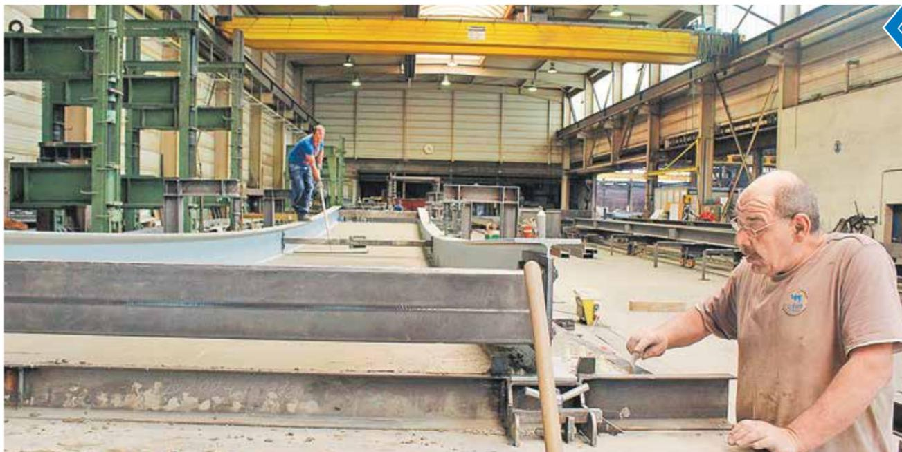
На заводе металлоконструкций компании Christmann & Pfeifer Construction GmbH & Co в немецком городе Брайденбахе бетоном покрывают металлоконструкции, применяющиеся в строительстве мостов и парковок
