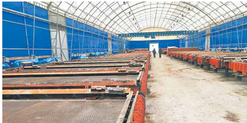
Быстроразворачиваемый технологический комплекс по производству железобетонных предварительно напряженных дорожных плит ПДН
